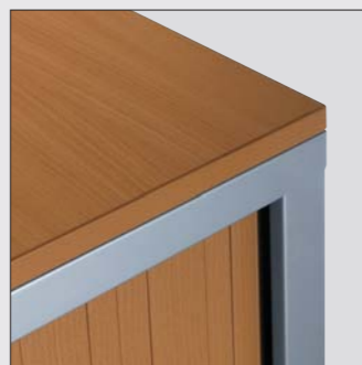
Dessus d'armoire Les tops de finition sont réalisés en mélaminé d'épaisseur 25 mm. Les 4 côtés ont un chant plaqué en ABS d'épaisseur 2 mm.
