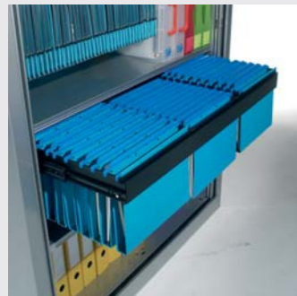
Châssis extractible. A partir de 2 châssis, il est indispensable d'utiliser des châssis antibasculants. Ce système d'ouverture sélective évite le risque de basculement de l'armoire en interdisant l'ouverture de plusieurs châssis simultanément.
